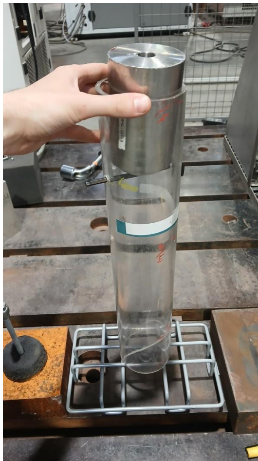
Photographie n°1: Montage pour essai IK10
