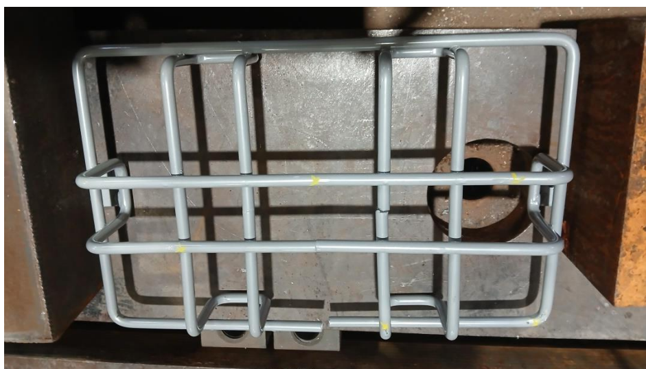
Photographie n°2: Grille de protection après essai IK10
